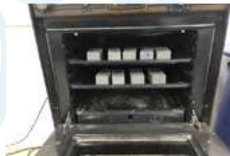
Figura 2. Probetas de roca en horno para secado
