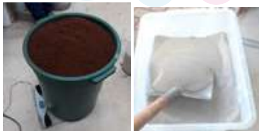
Figura 1. Materiales analizados: a) suelo residual basáltico b) RC-fino
