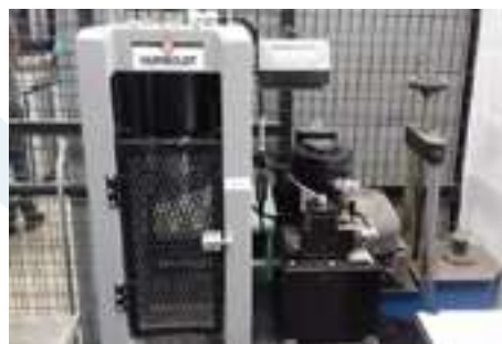
Figura 4. Máquina de compresión Humboldt
