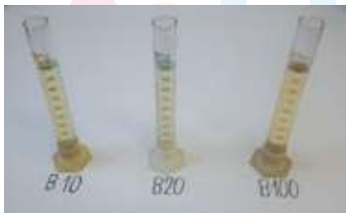
Figura 2. Biocombustible mezclas B10, B20 y B100
